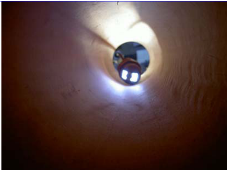
ingresso di una telecamera in una tubazione
