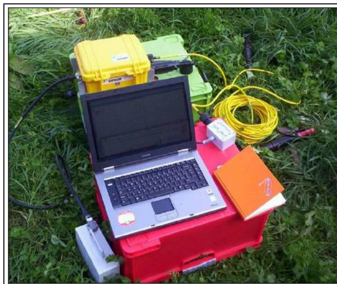
Figura 7.3: Strumentazione utilizzata per la prova MASW.
